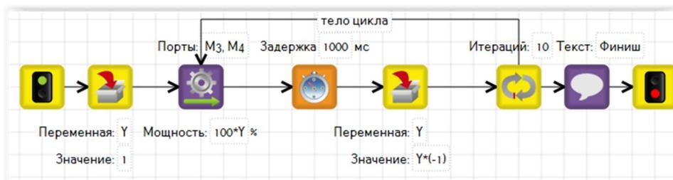
В этой задаче переменную  $Y$  мы объявляем 11 раз, и на каждом шаге ее значение разное, либо 1, либо (-1). Заметим, что мощность моторов также является величиной переменной: 100 или (-100). И еще одно наблюдение: при мощности (-100) действие «Моторы вперед» становится действием «Моторы назад».
