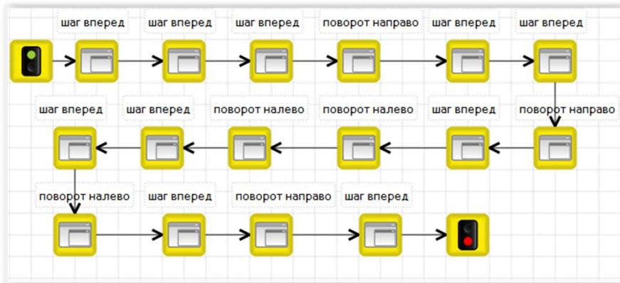
В случае если лабиринт неизвестен, необходимо использовать датчик расстояния для обнаружения стены, преграждающей дорогу. Основные алгоритмы прохождения лабиринта будут рассмотрены после изучения конечных и бесконечных циклов.
