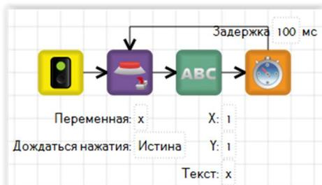
Вывод на дисплей кода кнопки. Свойство «Вычислять» блока «Напечатать текст» – Истина.
